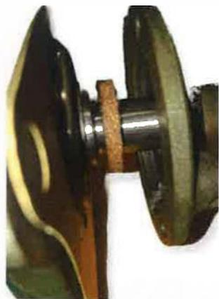
Placer le joint papier sur la face avant de la boîte et le joint liège graissé sur les deux faces sur le pignon a queue.
