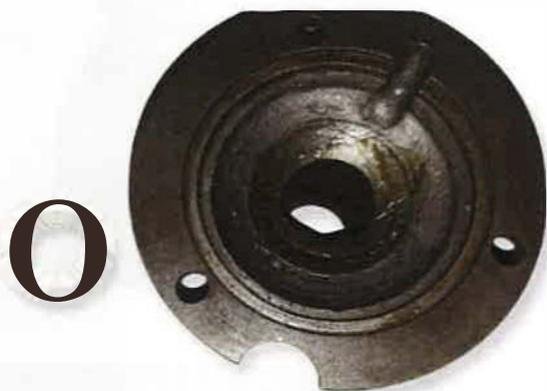
Graisser la tulipe porte butée au niveau de la portée du joint liège
