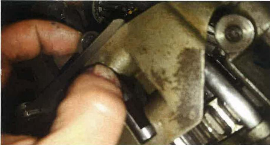
Controler le jeu entre la grille sélective et la fourchette de seconde. Vitesse de seconde enclenché, celui-ci doit être de 0,20/0,40 mm.
