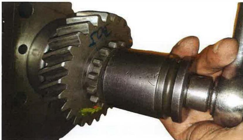
Immobiliser la rotation des pignons, et serrer l'écrou. Le pignon va pousser le roulement sur l'arbre à cannelure et dans le carter
